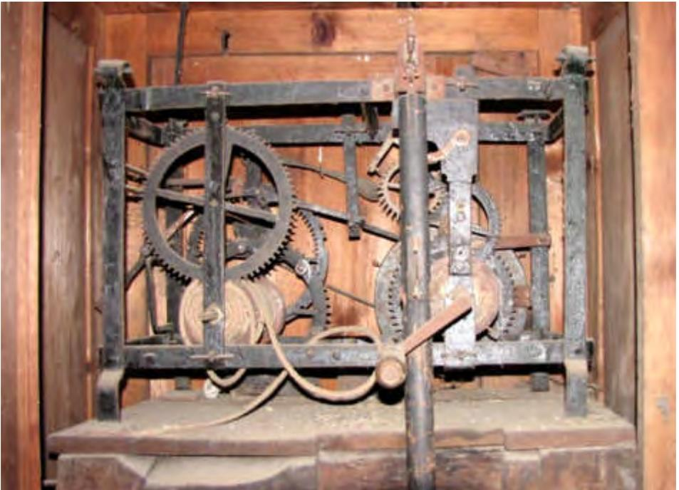
*Das Uhrwerk im Schrank, die Bauweise mit den nebeneinander angeordneten Seilwalzen ist deutlich zu erkennen, rechts das Gebwerk, links das Schlagwerk. das sehr massive Untergestell sorgt für sicheren Stand und Halt.*
