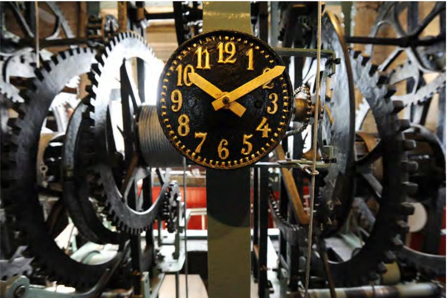
*Das Uhrwerk, wird über eine umgebaute Standuhr seit ca. 100 Jahren elektrisch und Minutengenau gesteuert. Die Steuerung ist von der Firma Michiels, Mechelen.*
