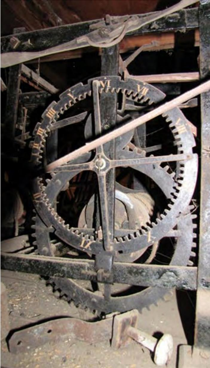
*Ausschnitt Schlagwerk, im Vordergrund die innenverzahnte Schlossscheibe, oberhalb der Windflügel, als Hilfe zur richtigen Schlageinstellung sind die "Schlagsegmente" der Schlossscheibe mit römischen Zahlen gekennzeichnet.*
