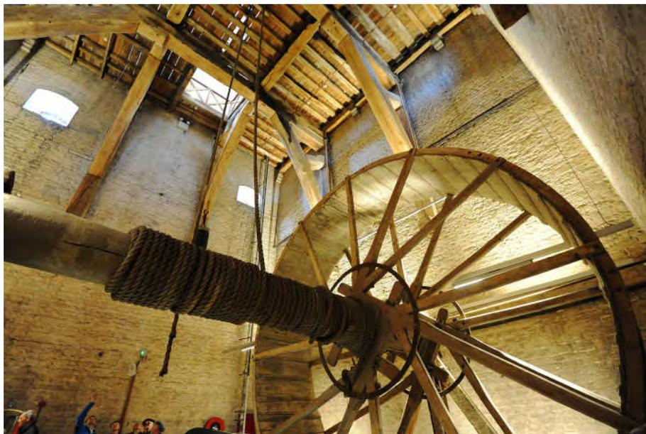
*Sint-Romboutskathedraal in Mechelen, der Lastenaufzug ist noch funktionsfähig*
