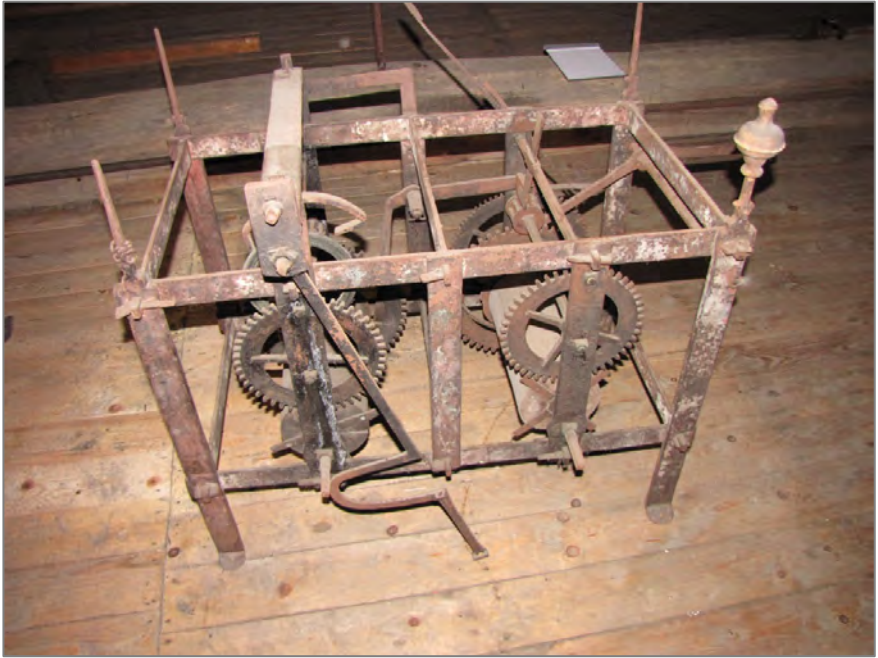
Gehwerk links Stundenschlagwerk rechts angeordnet
