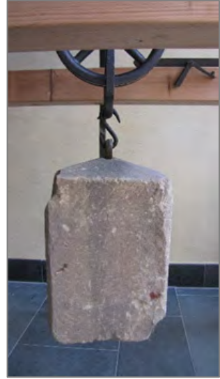
Das Antriebsgewicht für das Gehwerk
