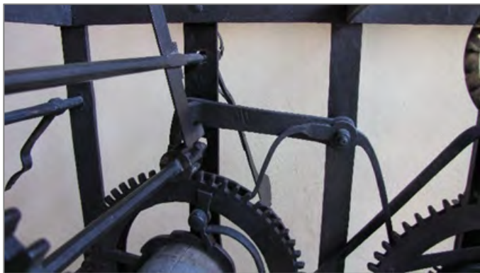
Das Hebelsystem für das Viertelschlagwerk
