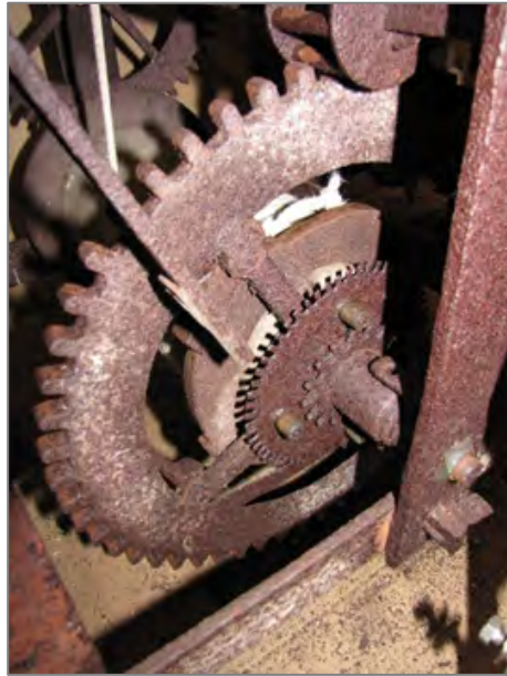
Unvollständiges Vorgelege, vom Bodenrad ausgehend.
