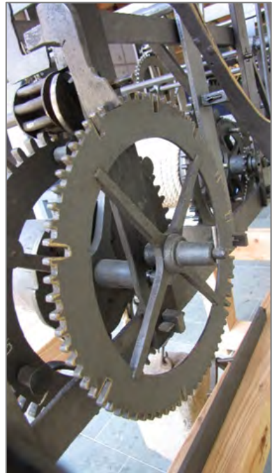
Die außenverzahnte Schlossscheibe für das Stundenschlagwerk
