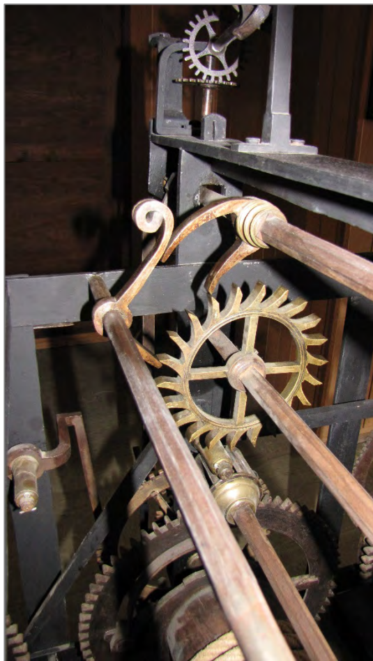
Die Bethune Hemmung, rückführend, hat zwei getrennte Achsen die mit einem Gelenk verbunden sind. Diese Art von Hemmung ist bei Turmuhren selten anzutreffen.
