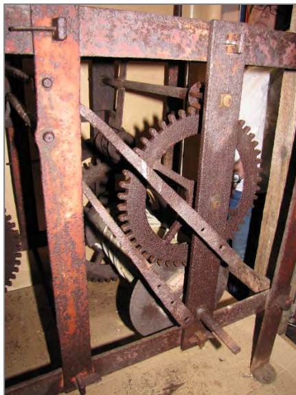
Details Stundenschlagwerk, rechts im Bild die beiden Hammerhebel für den Doppelschlag
