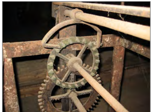
Dreieckige Stifte am Hemmungsrads, 45° abgeschrägt
