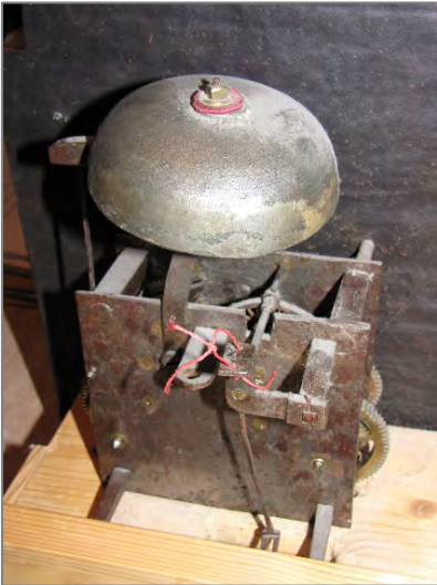
Das eiserne Vollplatinenwerk
