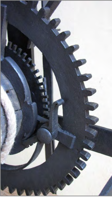
Das Walzenrad mit Sperrrad, Sperrkegel und Feder
