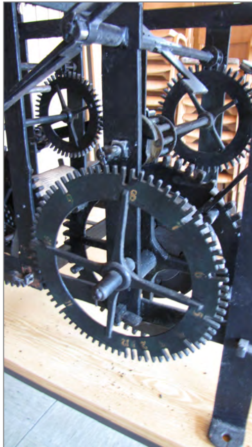
Stundenschlagwerk, mit außenverzahnter Schlossscheibe
