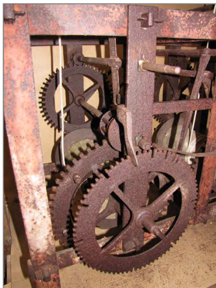
Details Stundenschlagwerk, rechts im Bild die beiden Hammerhebel für den Doppelschlag
