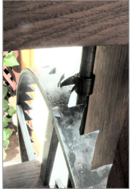
Der gebogene Spindellappen taucht in das Hemmungsrad ein
