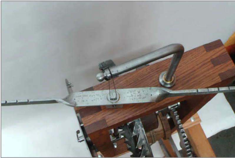
Die Aufhängung der Waag an einem „Faden“
