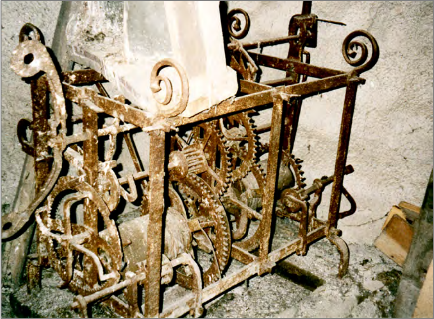
Ein geschmiedetes Turmuhrwerk, das vergessen und dem Verfall preisgegeben, auf seine fachgerechte Reinigung und Restaurierung wartete.
