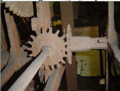
Sternweiserrädchen (als Winkelgetriebe) modernes Zeigerwerk, Quelle: Seebaß
