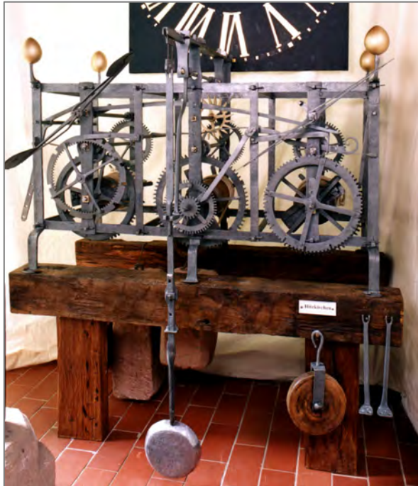
Turmuhrwerk aus Hitzkirchen, Werkanordnung „Seite an Seite“
