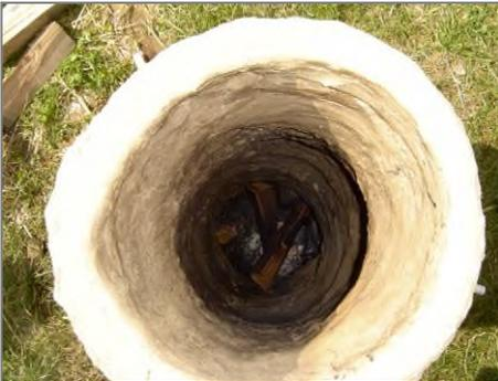
In der Schlackenrube, das ist der untere Teil des Ofens, der im Erdreich ist, wird ein kleines Feuer mit wenig Brennmaterial entzündet. Ein sanfter Trocknungsprozess wird eingeleitet und der Lehm verfestigt sich.
