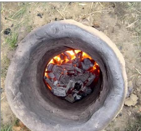
Die Feuertemperatur wird langsam erhöht. Jetzt brennt Holzkohle. Die Aufnahme des Erzes und des Brennstoffes ist eine nicht unerhebliche Belastung für die Wandung des Ofens.
