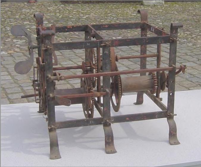
Dieses kleine, geschmiedete und nicht mehr komplette Turmuhrwerk wiegt 60 kg. Nachstehend eine Zusammenstellung von Zeitaufwand und Rohstoff für die Gewinnung der erforderlichen Menge an Eisen:
