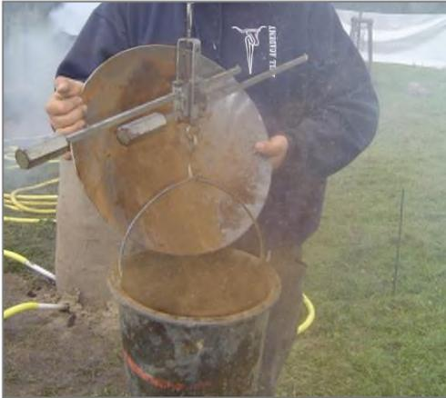
Die Vorbereitung der Befüllung: zuerst wird festgestellt, welches Gewicht das Brennmaterial hat, in diesem Fall ist es trockener Torf. Später wird dann auch das Erz gewogen.
