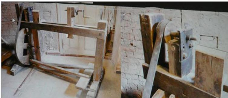
*Eine Drechselbank mit Fußantrieb Quelle:<sup>4</sup>*
