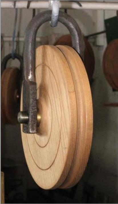
Eine hölzerne, gedrechselte Seilscheibe aus Eichenholz. Von einem Drechsler in Handarbeit angefertigt für den Einbau in die Gewichtsanlage einer historischen Turmuhr.
