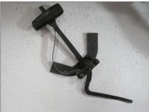
*Ein geschmiedeter Schlaghammer mit einem Befestigungsbügel zur Montage außerhalb der Glöcke. Glocken werden geläutet, dann schwingen sie. Glocken werden geschlagen, dann sind sie im Stillstand.*
