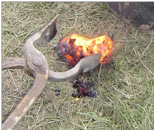
Luppe ist der schlackenhaltige, schwammartige Eisen- oder Weichstahlklumpen, der im Rennofen entsteht. Der glühende Brocken erlaubt noch keine Aussage darüber, welcher Anteil an Eisen enthalten ist. Es kann auch nur glühende Schlacke sein.
