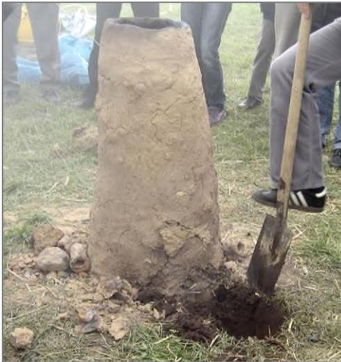
Die Frage lautet: „Kann die Schlacke schon abgestochen werden?“ Eine Probe wird entnommen, Schlacke hat sich an der Eisenstange festgesetzt, von der Beurteilung hängt es ab, ob der Verhüttungsvorgang als abgeschlossen angesehen werden kann. Die Probe deutet daraufhin, dass alles gut verlaufen ist. Der „Abstich“ der Schlacke wird vorbereitet und die Schlackengrube ausgehoben. In diese Grube wird die flüssige Schlacke „rennen“.
