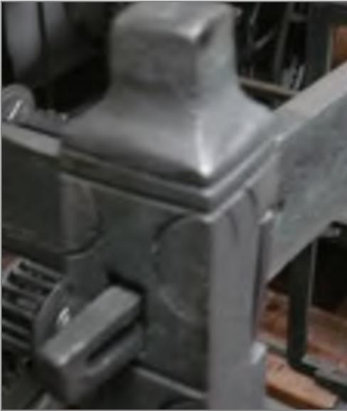
Eckverbindung einer geschmiedeten Turmuhr. Der Querriegel ragt aus dem verzierten Eckpfeiler und es ist der Schlitz für die Keilverbindung deutlich zu sehen.
