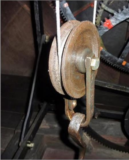
Für die Aufnahme der Seilrollen in Haltebügel und für Seilhaken waren stabile geschmiedete Einzelteile erforderlich.
