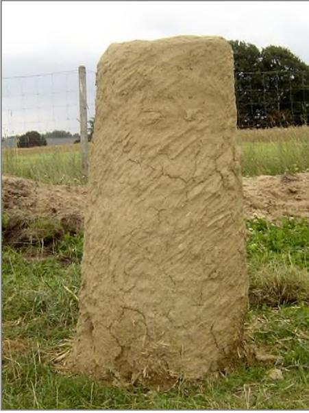
Der fertig errichtete Rennofen. Der Lehm wurde mit gehacktem Stroh vermisch um die Haltbarkeit zu unterstützen. Die Ofenhöhe beträgt ca. 80 cm. Der Durchmesser außen ca. 50 cm. Die Wand ist ca. 6 bis 10 cm. dick.
