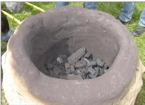
Pro kg Holzkohle werden bei der Verbrennung etwa 29 bis 33 Megajoule (MJ) an Heizenergie frei. Sie verbrennt schwefelfrei. 3,6 MJ entsprechen einer Kilowattstunde (kWh).
