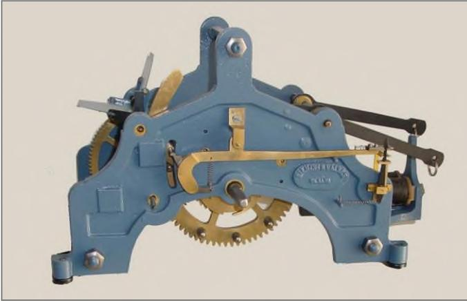
Industrieschlagwerk von Siemens & Halske mit elektrischer Auslösung der „Vaterunser Glocke“, ausgestellt im Technischen Uhrenmuseum Chemnitz e.V. Die Abbildung ist aus dem nachstehenden Buch:
