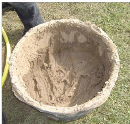
Lehm ist das wichtigste Baumaterial für die Errichtung eines Rennofens. Vermischt mit kleingehacktem Stroh als Bindemittel wird daraus der runde Ofen errichtet.
