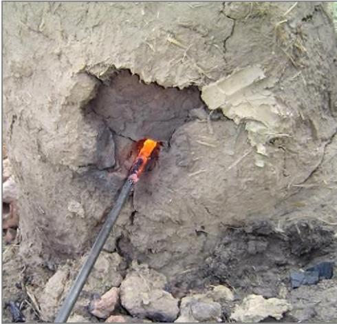
Der Verhüttungsvorgang im inneren des Rennfeuers kann von außen nicht einfach beurteilt werden. Es ist viel Erfahrung notwendig um aus der Beobachtung von austretendem Rauch und der nachrutschenden Ofenfüllung eine Prognose zu wagen. Die Zeitdauer ist dabei auch entscheidend. Es wird dann eine Öffnung in den Rennofen gestoßen um den Verhüttungsstand zu überprüfen.
