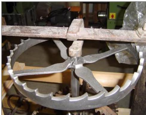
Dieses Steigrad einer Turmuhr mit Spindelhemmung wiegt 300 Gramm
