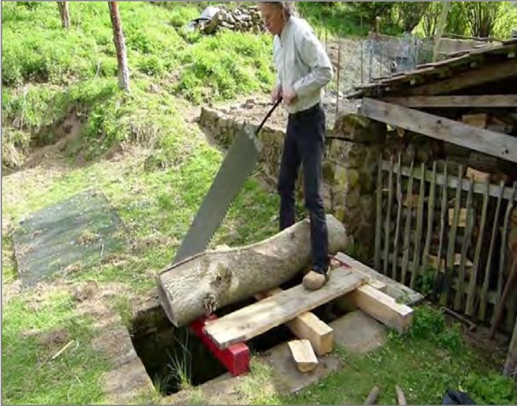
*Die Kransäge, eine „Einmann-Säge“ ergibt einen feinen Schnitt.*
