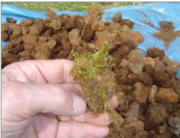
Raseneisenerz, hier ist deutlich zu erkennen, dass dieses Erz unmittelbar an der Erdoberfläche gefunden wurde
