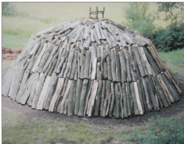
*Der aufgeschichtete Meiler, er wird mit Grassoden abgedichtet, dann wird das Feuer entzündet*
