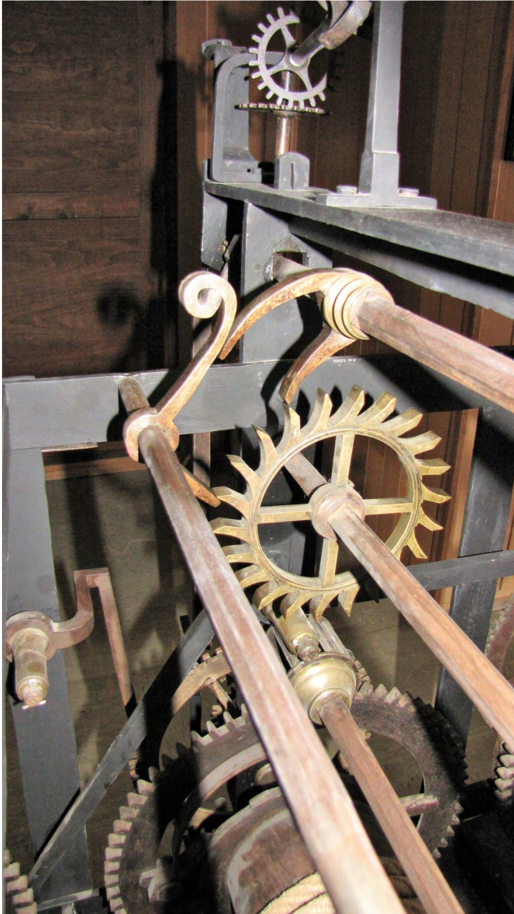
Hemmung einer Turmuhr, angefertigt von Meister Henn aus Odernheim in der Pfalz
