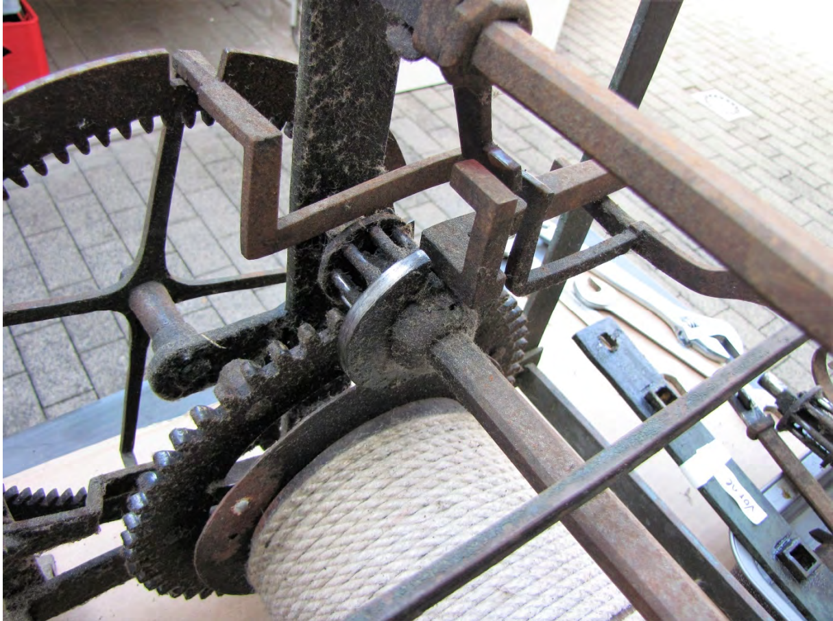
Das noch montierte Schlagwerk, vor der Demontage und der Reinigung.
